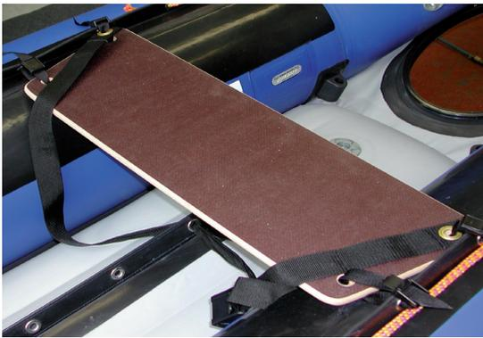
**ANBRINGEN DER SCHENKELHALTERUNGEN** — Die Schenkelhalterungen werden am Boden durch eine Ösen gezogen und dann über die Sitzbretter gebunden. Das Otter besitzt einen Panikverschluss für die Schenkelhalterung, damit Sie sich im Falle einer Kenterung problemlos befreien können.
