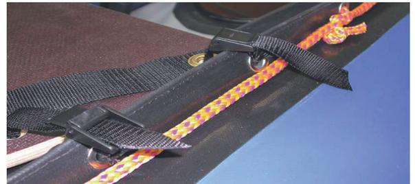
**ANBRINGEN DER SITZBRETTER** — Nehmen Sie dazu die mitgelieferten Einbindeschnüre und fädeln Sie diese durch eine Öse und den unter der Sitzbrett und durch die Löcher. Klippen Sie fest. Nochmal einen Panikverschluss bei Kenterung problemlos zu befreien.
